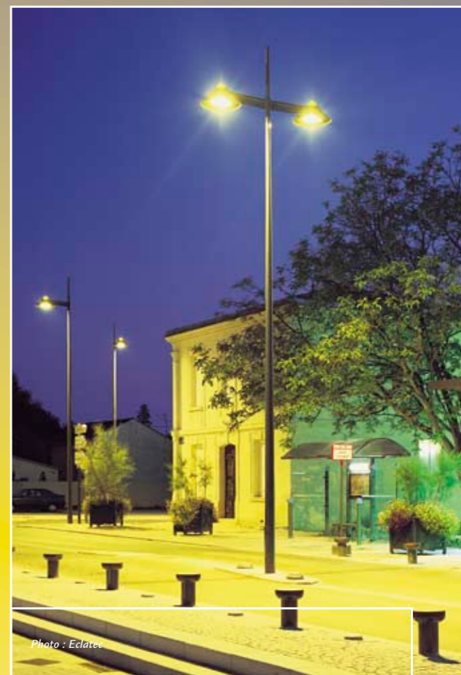
Rue Chaussée et trottoirs Lampe au sodium haute pression 150 W et 250 W Autour de l'hôtel de ville, Bruges (33)
